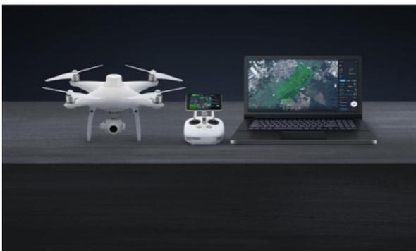
本项目作业采用大疆 Phantom 4 RTK 无人机正射影像。Phantom 4 RTK 是一款小型多旋翼高精度航测无人机，结合厘米级导航定位系统和高性能成像系统，提升了航测效率与精度，降低了作业难度和成本。
